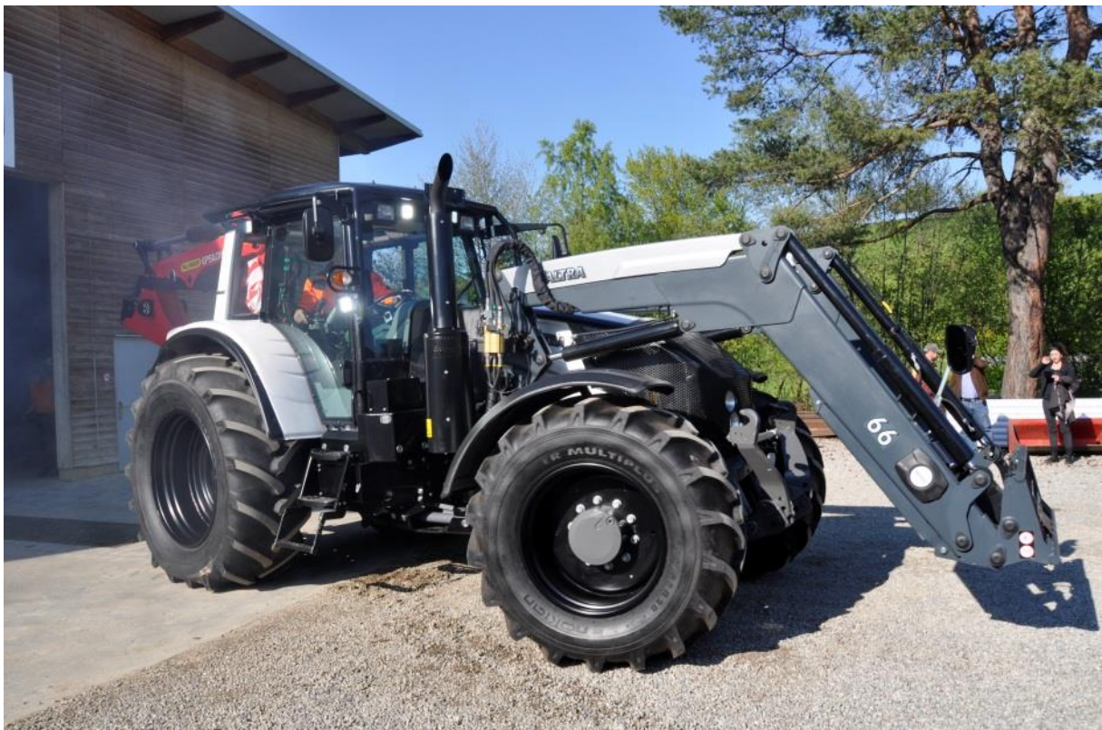
Der neu Valtra XN163, mit kombinierter Front- und Knicklenkung, Frontlader, Fronthydraulik und Rückekran.
